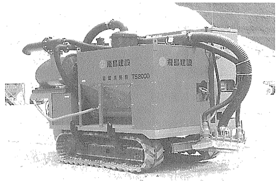
写真—1 岩盤清掃機
