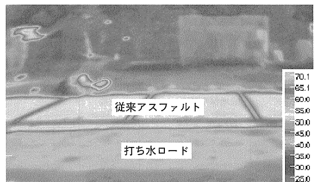
写真—3 打ち水ロードの表面温度（サーモカメラによる熱画像）
