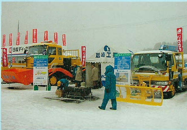
↑バケットローダ(2.0m³)型とプラウ付除雪トラック
