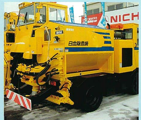
↑薬剤散布装置付マルチ除雪車(車両幅1.3m) ↑
