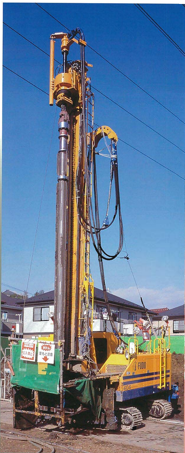
↑高さ制限下・狭隘地用小型機械 (翼径1.2m、貫入深度11m伸縮式)
