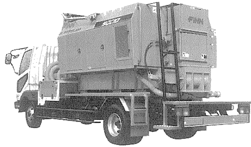
写真-8 新キャタピラー三菱「SOCIO」BB 605 破砕木材吹付け機
