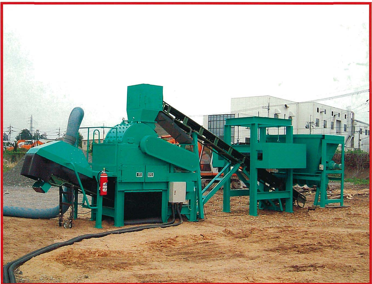
定置式木質系二次粉碎機 FPP 550 古河機械金属株式会社
