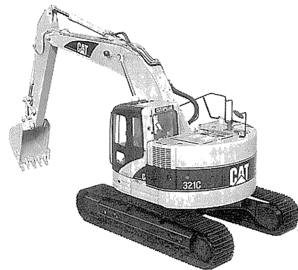
写真二 CAT 321 C CR 「REGA」油圧ショベル (後方超小旋回形)
