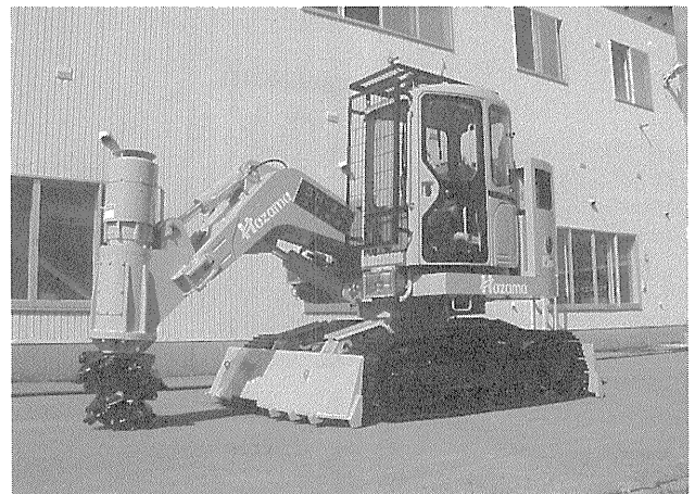
写真-4 自走式立坑掘削機「シャフトヘッダー」
