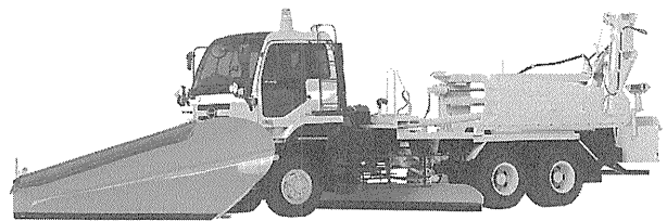
写真一 7 日野自動車 KL-HZ 55 E (改)/6×6 除雪トラック (ワンウェイブラウ・グレーダ・サイドウイング付き)
