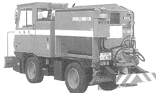
写真—6 日本除雪機製作所 MV 80 多目的作業車（凍結防止剤散布装置付き）
