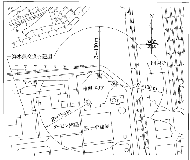
図-3 クレーン使用可能エリア
