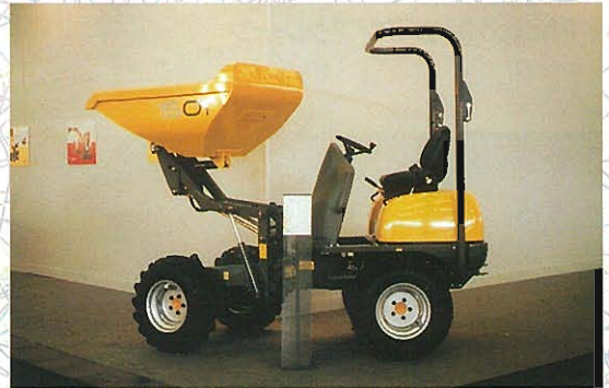
Photo31/⇨ 海外に多いフロントミニ ダンプトラック
