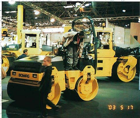
Photo24/ボーマクの⇨ 小型振動ローラ (ヒンジ式ROPS付)
