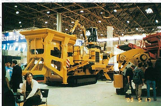
⇧Photo27/自走破碎機
