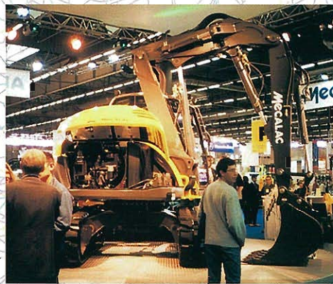
Photo15/超小旋回形ショベル⇨ (アームシリンダーが腹側にある)
