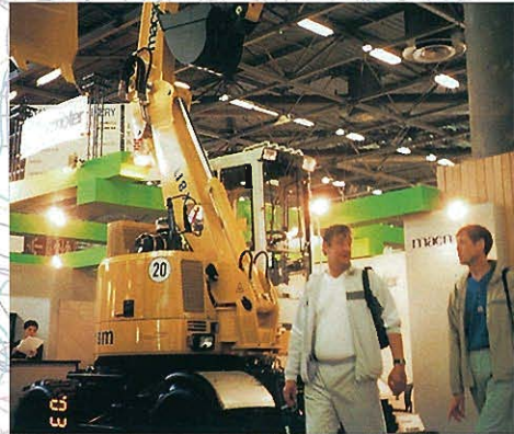
⇨Photo14/ 車輪式スイングブーム式 超小旋回形ショベル
