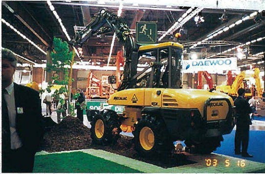
⇨Photo13/車台側にエンジンのある 車輪式油圧ショベル
