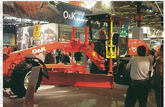
⇧Photo32/ レーザ用プリズムを装着したO&Kグレーダ
