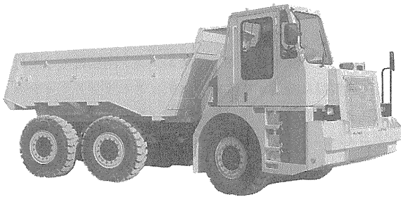
写真-6 川崎重工業 KUT 300 坑内用ダンプトラック
