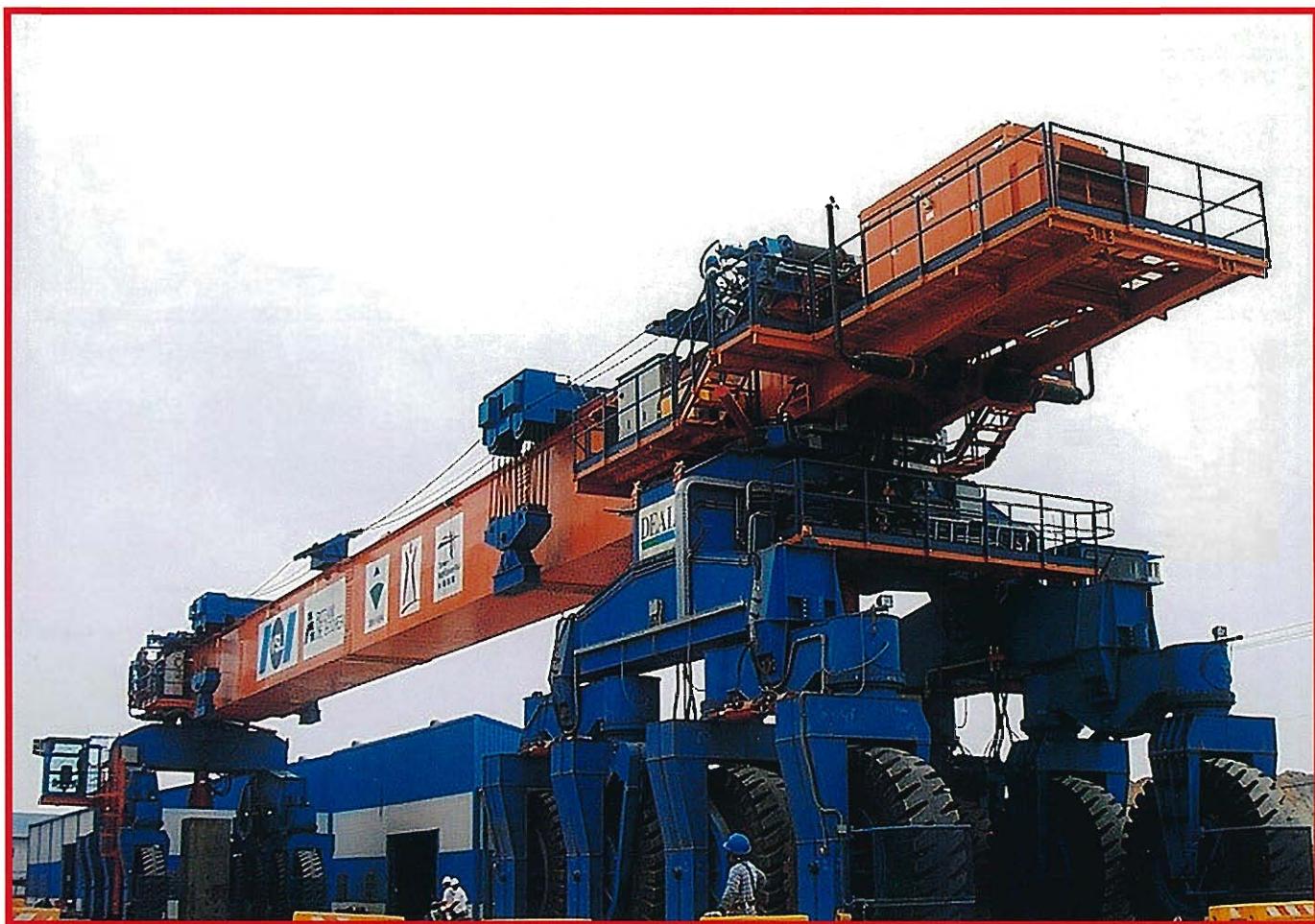
プレキャスト桁を積載したラウチングキャリア
