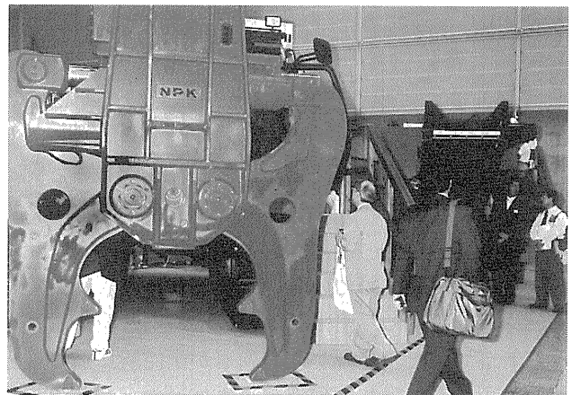
写真-2 解体機械のアタッチメント部
