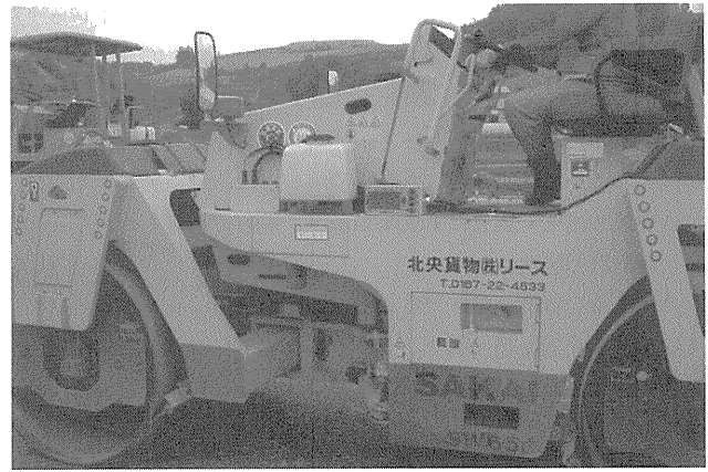
写真-7 振動ローラに取付けられた締固め評価システム
