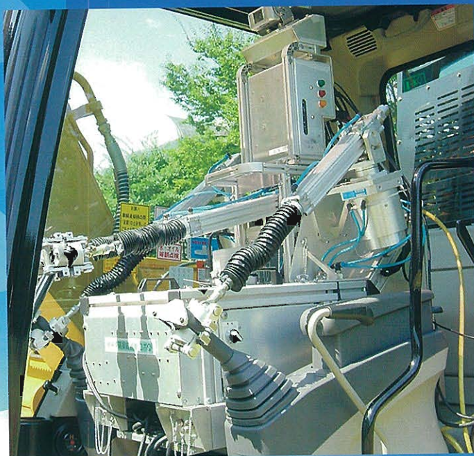
バックホウに搭載した遠隔操縦ロボット⇒
