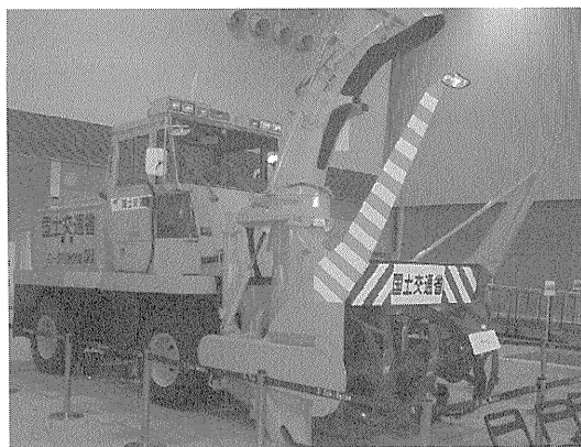
写真二 除雪機械の自動運転 (ITS) (建設フェア in 北陸 2003 にて)
