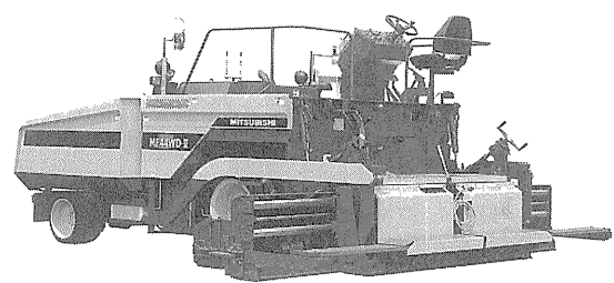
写真—10 新キャタピラー三菱 MF 44 WD II アスファルトフィニッシャ
