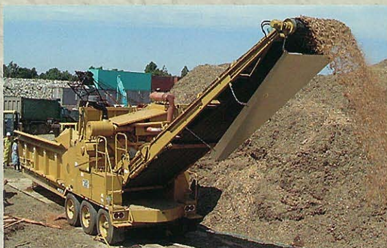
⇩伐採、仮置きされた廃木材を粉碎作業中
