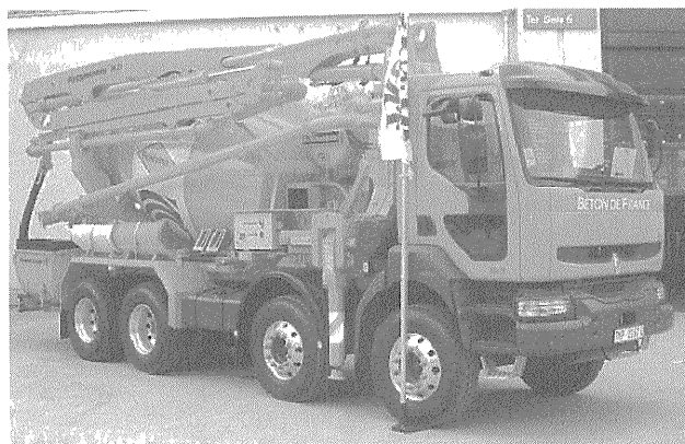
写真—21 ブームとコンクリート圧送装置を搭載した生コンミキサ車 (Putzmeister 社製)
