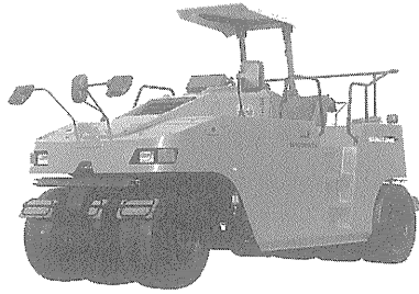
写真-6 住友建機 HN 200 WTK-3 タイヤローラ
