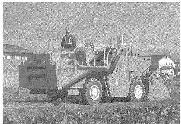
写真-10 フォームスタビライザ「KS-200」 (狭隘な町道工事におけるフォームドアスファルト施工)
