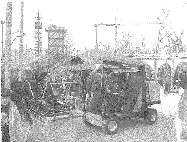
写真—35 インターロッキング設置機械
