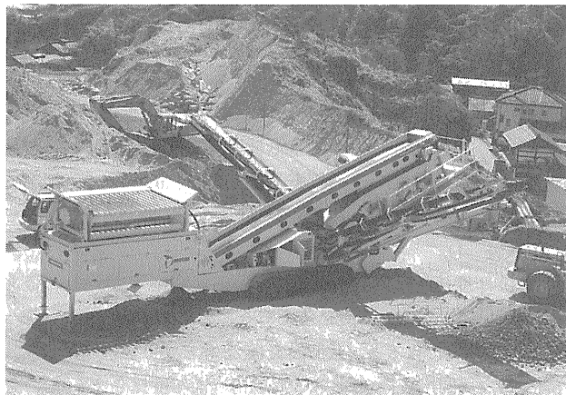
写真4 メットソ・ミネラルズ・ジャパン「ノードバーク」ST 352 振動ふるい機 (自走式)
