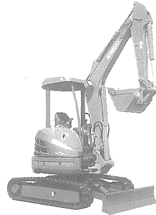
写真一 コベルコ建機「ビートル」SK 35- 3 ミニショベル (後方超小旋回形)
