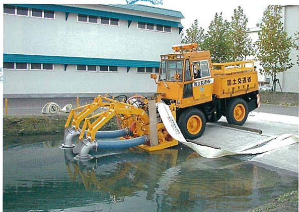
⇩排水ポンプ装置の性能確認試験
