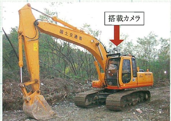
写真-31 / 無人化施工用油圧ショベル
