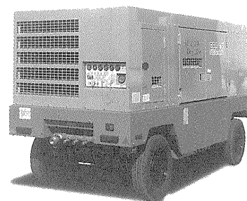
写真-5 デンヨー DIS-685 ESS-D 空気圧縮機（被けん引式）
