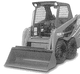
写真-1 TCM「SSL」706 ホイールローダ (スキッドステアリング形)
