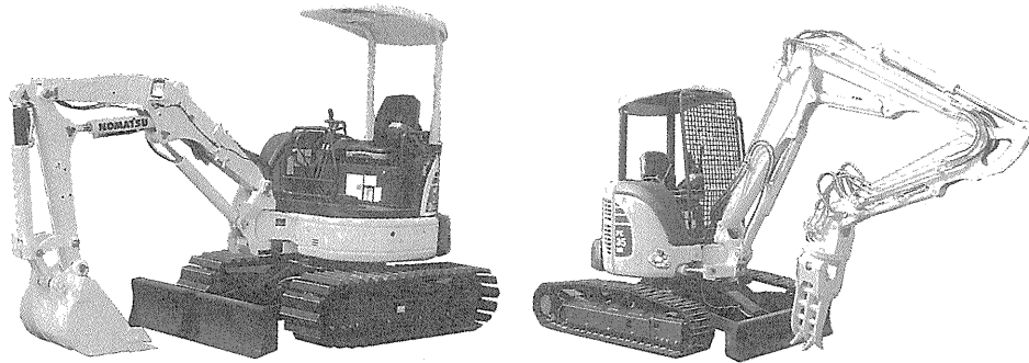
写真-4 コマツ「GALEO」PC 35 MR₂基礎掘削機（左）と解体破碎機（右）
