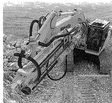
写真-4 コマツ「GALEO」BP 500 7 自走式割岩機
