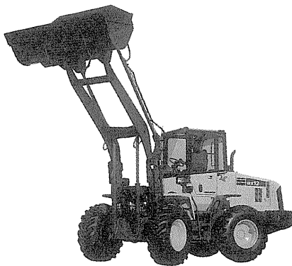
写真-1 コマツ「GALEO」WR 12 s ホイールローダ（リーチ形）
