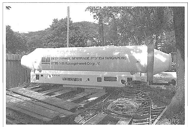
写真-12 コンクリート吐出しが両端から行える特殊タイプの9m 3 容量のアジテータカー
