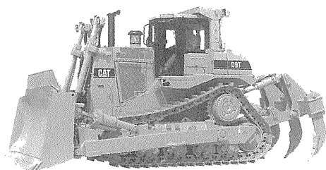
写真一 新キャタピラー三菱 CAT D 9 T ブルドーザ
