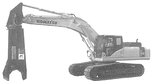
写真二 コマツ「GALEO」PC 300 LC 7 油圧ショベル（解体破碎仕様機）
