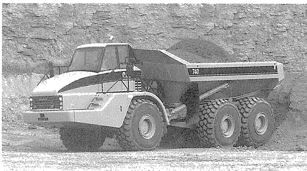
写真-4 新キャタピラー三菱 CAT740 重ダンプトラック (アーティキュレート式)
