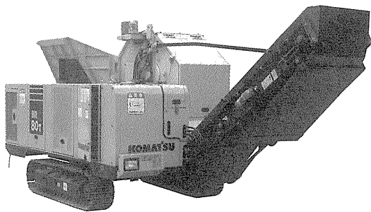
写真-5 コマツ「リフォレ」BR80T 1 自走式木材破碎機
