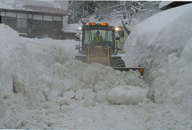
↑集落道路のタイヤドーザ雪崩除雪作業
