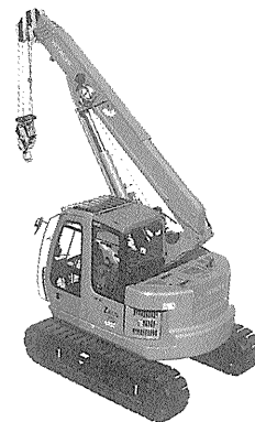
写真-5 日立建機 ZX 75 UST クローラクレーン
