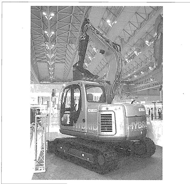
写真—8 コベルコ建機 ハイブリッドショベル (参考出品)
