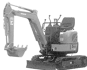
写真-3 日立建機「arc」ZX 10 U-2 ミニショベル (後方超小旋回形)
