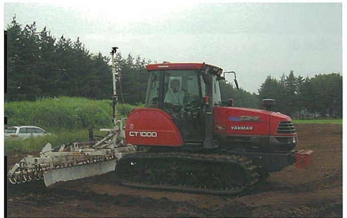
⇩ GPS制御による圃場面の均平化
