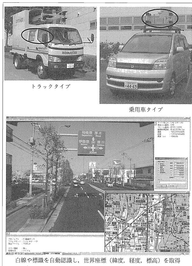
図-8 GPS との組合せ（計測車の目）
