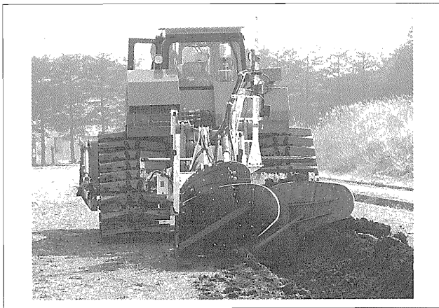
写真—2 反転均平工法用特殊車両 D6R と二段耕プラウ
