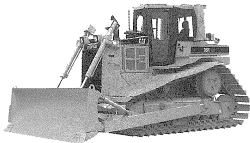
写真-1 新キャタピラー三菱CAT D 6 R SERIES IIIブルドーザ (湿地車)
