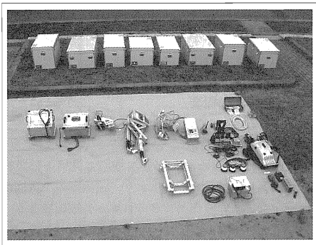
写真-2 ロボ Q 装置分割状況 (写真はブルドーザ用)
