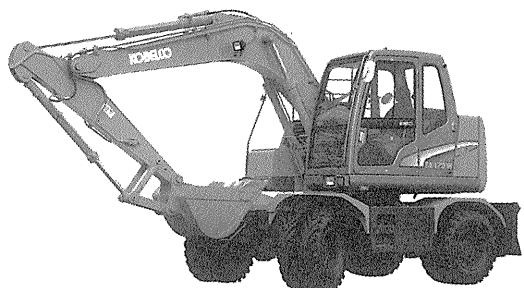
写真-1 コベルコ建機 SK 125 W 油圧ショベル (ホイール式)
