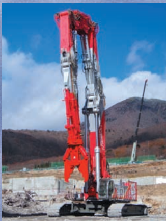
⇨65 m も OK ! 世界一ノッポのビル解体機
