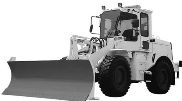
写真—2 高速除雪ドーザ
