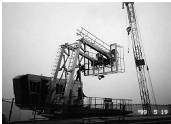
写真一 5 ガントリーの自力折り畳み状況
