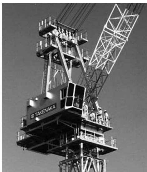
写真一 2 OTA-300Hのコンパクトな旋回フレーム
