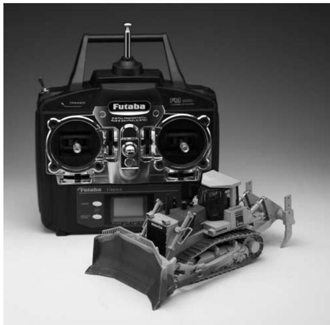
写真—3 ラジコンメカを組み込んだ1:50ブルドーザの試作品
