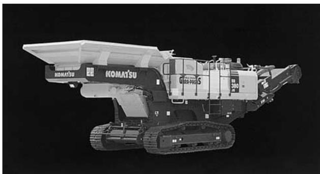
写真—4 コマツ「GALEO」BR380JG-1E0 自走式破砕機
