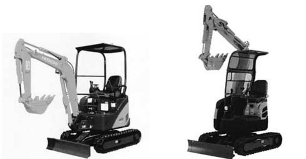
写真一 日立建機「arc」ZAXIS17U-2（後方超小旋回形）（左）と ZAXIS15UR（超小旋回形）（右）ミニショベル
