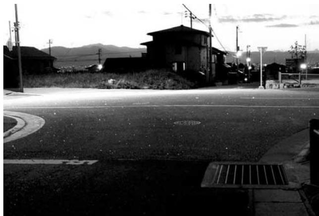
写真-7 光る骨材を利用した路面
